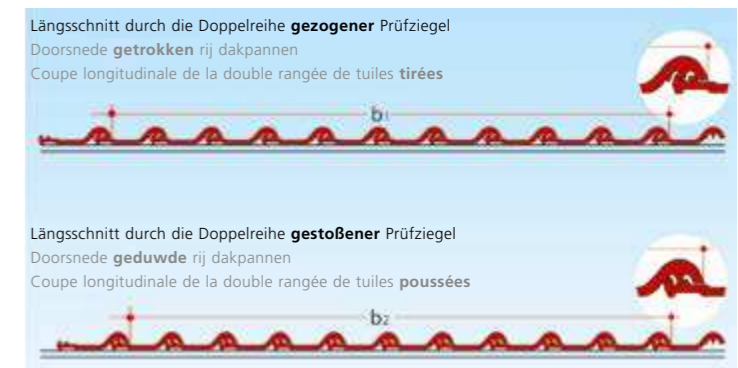
Orientierungs-Deckbreiten (cm) nach Anzahl der Ziegelreihen ohne GOZ oder Doppelkremper Dekbreedte (cm) met he aantal rijen dakpannen (ter orientatie)
