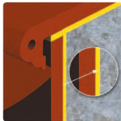
Грунтовка и гидроизоляция основы
